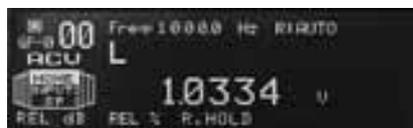
指示応答特性として、実効値応答の高感度交流電圧測定機能をもって
