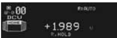
測定レンジは、フルスケールの30mV、300mV、3V、30V、100Vの5レンジで
