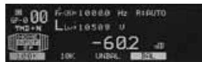
基本周波数範囲10Hz ~ 110kHzの全ひずみ率測定ができます。測定
