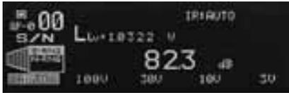
信号発生部出力のオン/オフと、S成分レベル/N成分レベル測定とを自動的に同期させることにより、S/Nキーを押すだけで自動的に測定できます。S成分、N成分レベル測定のレンジ切り換えは、オートまたはマニュアルでできます。最大130dBのS/N測定機能を有しています。
