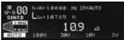
S成分(ノイズ、ひずみを含む)とN成分(ひずみを含む)についてACレベル測定を行い演算により算出して表示します。S成分のレンジ切り換えは、オートまたはマニュアルが選べます。N成分のレンジは固定で、0 ~ 40dBの範囲で測定が可能です。
