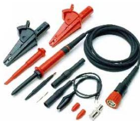
PPEシリーズには、2kV~6kVをカバーする4本の減衰率固定プローブと、減衰率を $\div 10/\div 100$ に切り替え可能な最大1.2kVのプローブがあります。減衰率固定の標準プローブを使用すると、互換性のあるテラデザイン・レクロイのオシロスコープは、適切なプローブ減衰比にあわせて自動スケールリングします。
