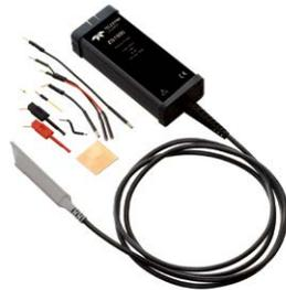
ZSシリーズのプローブは、広範なプローブ要件に対応するために、高インピーダンスとプローブ・チップおよびグラウンド・アクセサリの拡張セットを備えています。1M $\Omega$ の高い入力抵抗と0.9pFの低い入力キャパシタンスを持つ、あらゆる周波数に対して理想的なプローブです。ZSシリーズのプローブは、Probusインターフェース搭載のテラデザイン・レクロイのオシロスコープで、システム帯域幅をフルに活用することができます。
