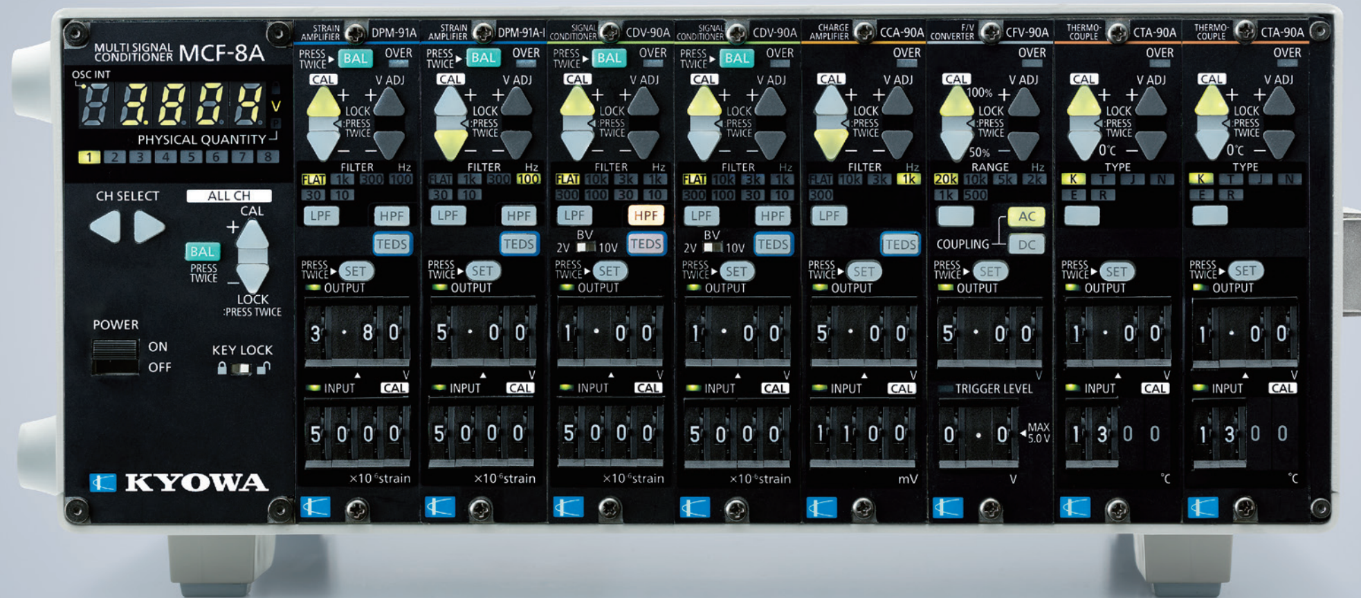
MCF-8A 原寸大 246.4(W)×101(H)×170(D)mm ※突起部は含まず
