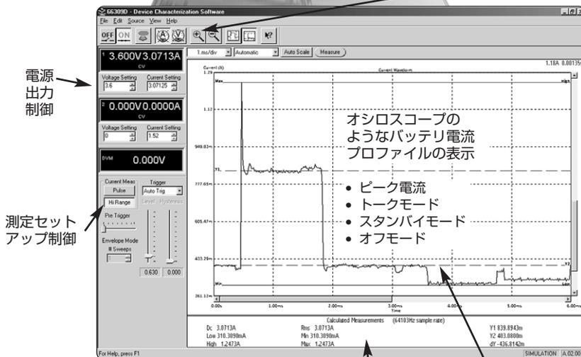
図4. バッテリー電流ドレイン・プロファイル
