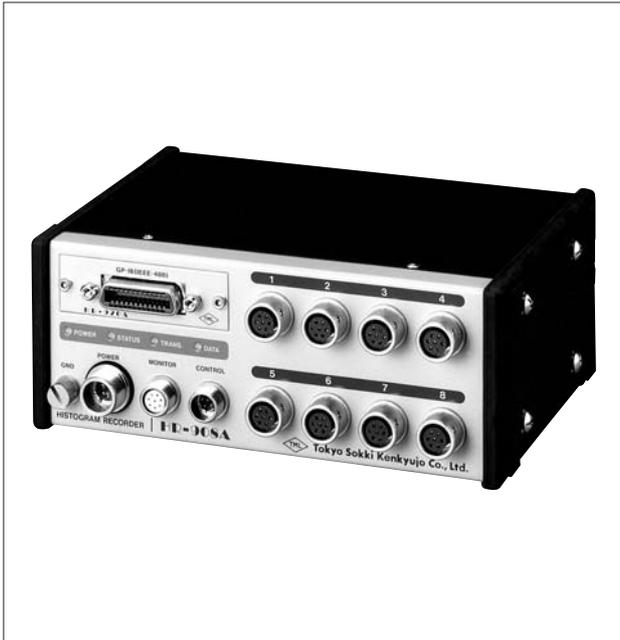
ひずみゲージ、ひずみゲージ式変換器などからのアナログデータをデジタル処理し、頻度解析を行うシステムです。ヒストグラムレコーダHR-908Aは豊富な解析プログラムと大容量メモリを備え、ふたつ以上のプログラムによる同時解析や、ファイル機能による複数回の頻度データ記録が可能です。実時刻タイマによるプログラム自動測定、最大±50スライスの分解能、波形記録など、多くの機能を備えています。電源はDC10.5~30Vで、長期にわたって安定した測定が行えます。初期設定や記録データの読み出しは、ヒストグラムレコーダ本体に装着のGP-IBまたはRS-232Cインターフェースによりパーソナルコンピュータを接続して行います。記録データを直接パーソナルコンピュータに転送できるため、汎用性のある計測システムを展開できます。
