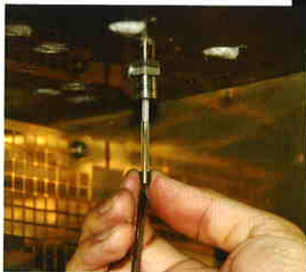
簡単なノズルの交換でキャピラリ、パックドカラムの両方に対応可能
