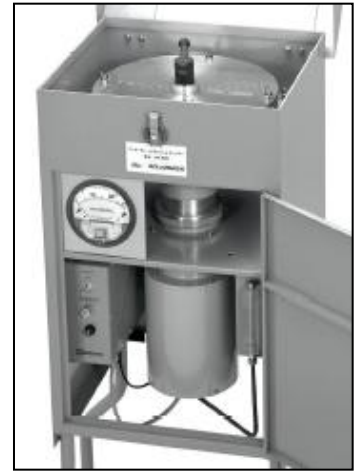
上の写真は、AH-600アンダーセンハイポリウム サンプリングヘッドを、フローコントローラー付ハイポリウムサンプラーに組み込んだ例です。
