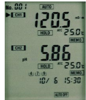
電気伝導率・pH同時表示例 WM-22EP型。
