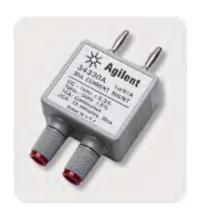
Agilent 34330A 電流シャントは高精度な  $0.001~\Omega$ 抵抗です。 このシャント抵抗を通る電流 1A あたりの出力は 1~mV です。 測定する電流をシャントにバインディング・ポストで接続します。
