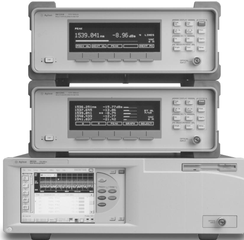
Agilentのマルチ・ウェーブレンクス・メータ・ファミリは、マイケルソン干渉計をベースにした測定器で、各モデルにより指定の波長レンジにおいてレーザー光の波長と出力パワーを測定します。複数のレーザー・ラインを同時に測定できるので、ファブリ・ペロー・レーザーのスペクトル・ラインやDWDM信号の測定に最適です。各レーザー・ラインを分離できる最小間隔(変調側波帯を含む)は、以下の通りです。
