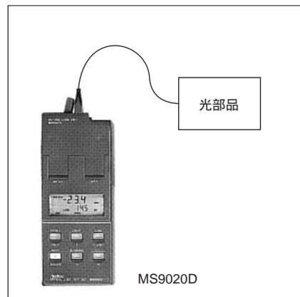
MS0907A反射率ユニットと組み合わせ、SMファイバ用光コネクタや光部品の光反射率をワンタッチで測定できます。
