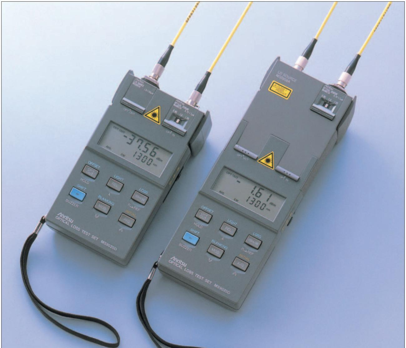
MS9020Dは、LED/LD光源と光パワーメータを一体化したハンディタイプの光損失測定器です。また、光反射率や光ファイバ破断点の測定器としても使用できます。LED光源、LD光源、光検出器、反射率ユニットの全ユニットがプラグイン方式で簡単に交換できますので、フィールドユースの測定に適しています。光損失測定では、0.66  $\mu\text{m}$ 、0.85  $\mu\text{m}$ 、1.3  $\mu\text{m}$ 、1.55  $\mu\text{m}$ 帯をカバーしています。
