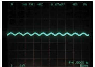
入力：1 kHz sin 波 50 mAp-p (オシロスコープの帯域 20 MHz)
