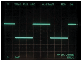
入力：10 kHz 矩形波 400 mAp-p (オシロスコープの帯域 20 MHz)
