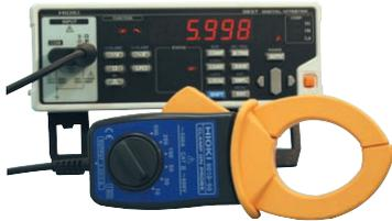
■ 電流波形観測や高調電流の解析に、メモリハイコーダ 8807/08 シリーズと合わせて波形観測 / 電流解析！
