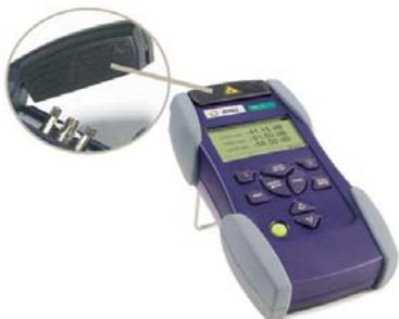
ダスト・キャップを締めるだけで、光反射減衰量テストの基準が設定されます。
