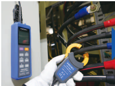
ディスプレイユニット CM7291 と センサを接続し測定部に設置します
