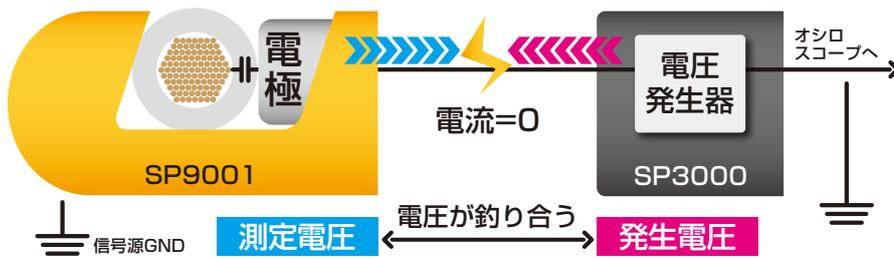
プローブ先端のフッククリップ部には測定ケーブルと容量結合させるための電極があり、測定ケーブルと電極の間に電位差があると微小電流が流れます。この微小電流を検出し、電流が0になるような電圧を発生させることで、さまざまな波形を正確に観測できます。
