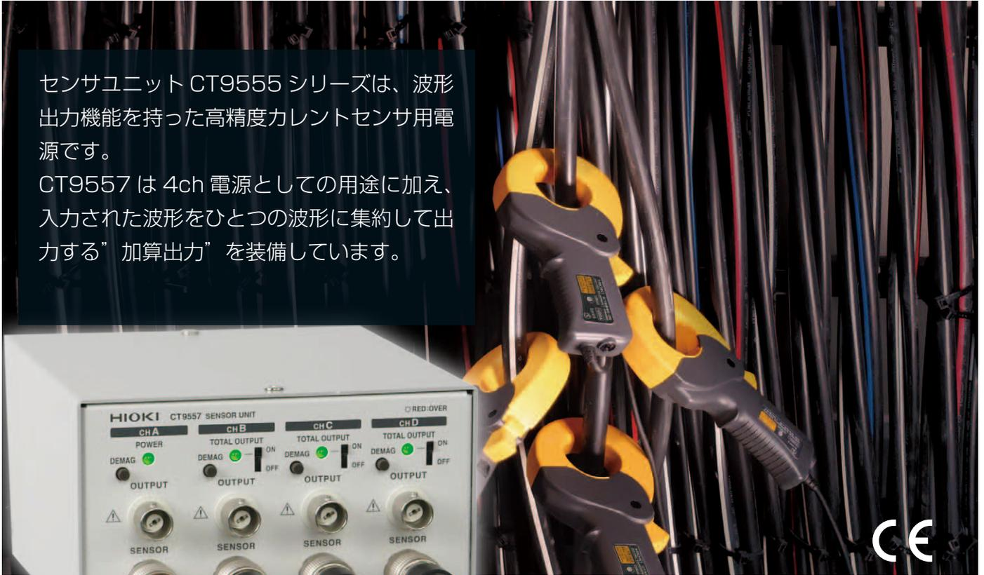
加算出力では最大4chの電流波形を加算し、2 V.f.s.の波形に変換して出力します。加算波形出力、加算RMS出力の2種類の出力が可能です。大容量のPVパワーコンディショナやインバータなど、定格やケーブル径の問題で測定できなかった現場でも測定可能です。
