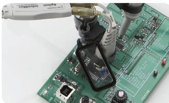
図 3. 付属の 3 倍の拡大鏡を使って、プローブの接触部を拡大して見ることができます。
