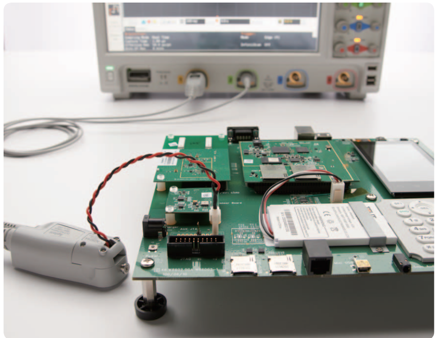
図1. Agilentの超高感度N2820A/N2821A電流プローブ(最小分解能50 \mu\text{A} )は、バッテリー駆動デバイスに多く見られる低い電流レベルを測定できます。
