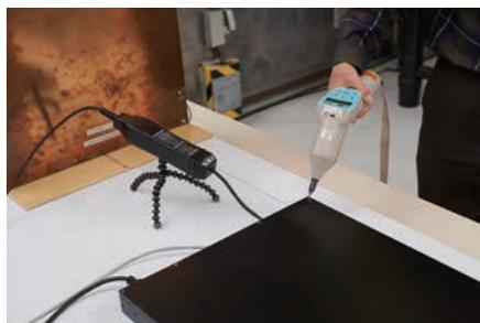
ノイズの伝搬経路解析では、サージ、トランジェント、EMIなどの電気的なストレスが測定値に影響を与え、製品から発生しているのか、リードやケーブルで拾われたノイズか判断できません。IsoVuではガルバニック絶縁によってこれらを分離することができます。また、10mのファイバにより物理的に距離を離すことも可能です。
