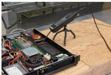
スイッチング電源、インバータ、コンピュータ、自動車、産業機器での電源の制御信号やシャント抵抗による電流測定では、デバイスがグランド接続されていないため、計測機を通してグランド接続すると問題を起こします。またスイッチングからのコモンモード・ノイズにより正しい測定ができません。IsoVuでは優れたCMRR特性とガルバニック絶縁により、安全、確実にフローティング測定が可能です。
