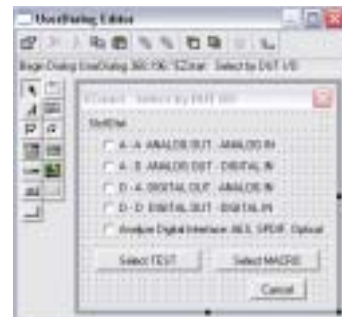
Dialog Editorを使用して、マクロ内のユーザ・インタフェース・パネルの設計
