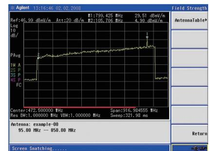
電界強度測定では、アンテナ係数を使用して、自動的に補正が行われます。アンテナ・テーブルは、N9340B PC ソフトウェアで定義できます。
