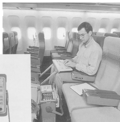
オプションUK4マイクロフォン・アダプタおよびパワー・サプライを使用した35670A
