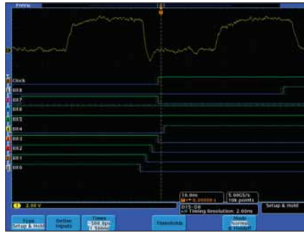
■ 多チャンネルのセットアップ/ホールド・トリガにより、複数の違反をハイライト表示 (MSO4000シリーズ)
