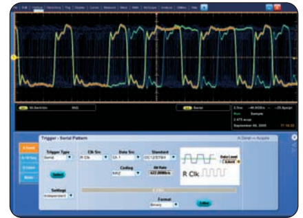
▶ パターン依存による問題をデバッグするためのシリアル・パターン・トリガ
