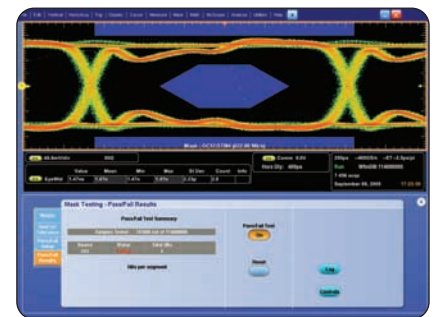
▶ 規格で定められたマスクによる622Mbps信号のテスト
