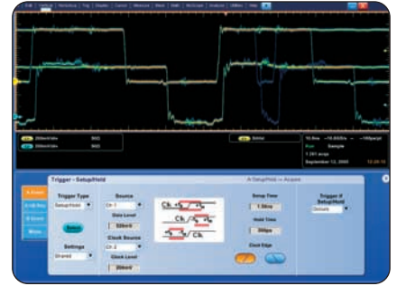
▶ 360psまでのセットアップ/ホールド時間違反を検出します。
