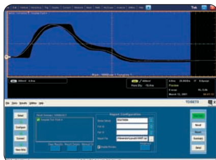
▶ Ethernetコンプライアンス・テスト
