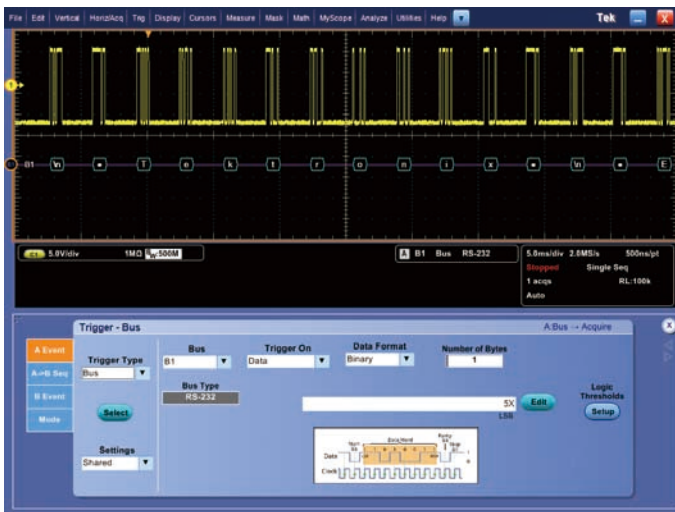
Capture(取込み) — RS-232バスの特定のデータ・パケットにトリガした例。特定のシリアル・パケット内容にトリガでき、すばやくイベントを取込むことができます
