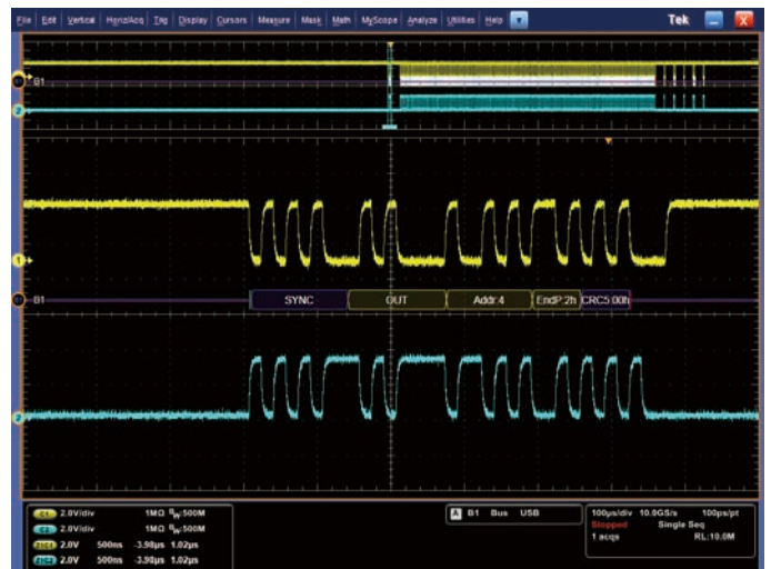
USBフルスピード・シリアル・バスの特定のOUTトークン・パケットにトリガした例。バス波形は、スタート、シンク、PID、アドレス、エンド・ポイント、CRC、データの値、ストップなど、デコードされたパケットの内容を表示
