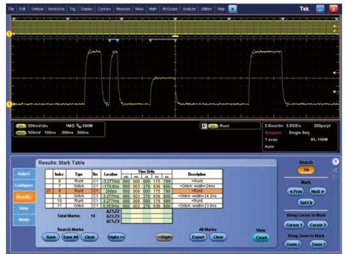
Search(検出) — 優れたサーチ機能により、長い波形メモリからラント・パルスまたは幅の狭いグリッチを検出。検出されたラントまたはグリッチには自動的にマークが付き、容易に参照できる
