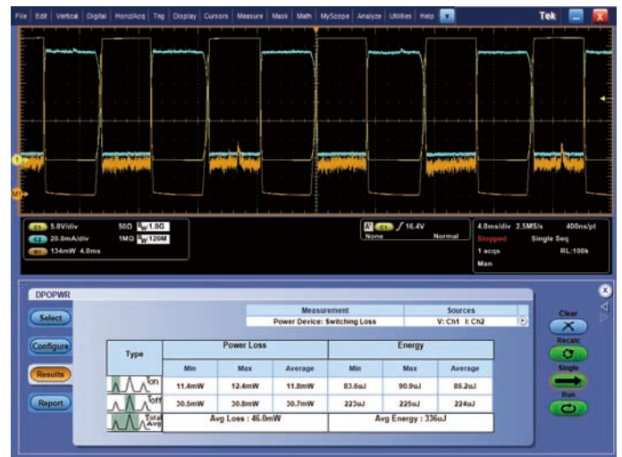
安全動作領域測定。自動パワー解析オプションにより、パワー回路のパラメータを簡単に、正確に測定可能
