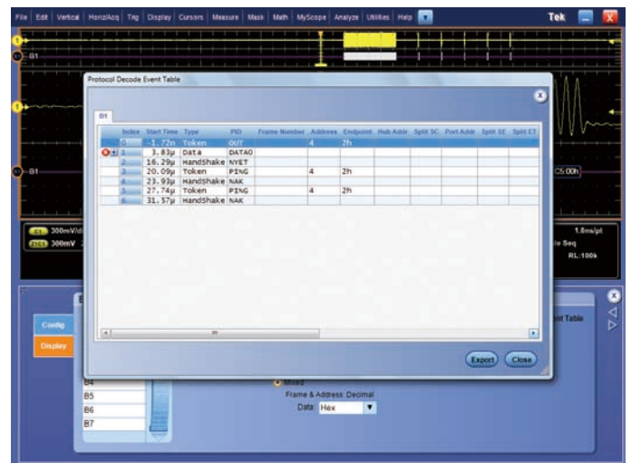
ロング・メモリに取込まれた、デコード・シリアル・パケットのイベント・テーブル表示
