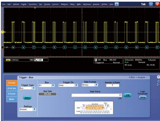
取込み — RS-232バスの特定のデータ・パケットにトリガした例。特定のシリアル・パケット内容にトリガでき、すばやくイベントを取込むことができます
