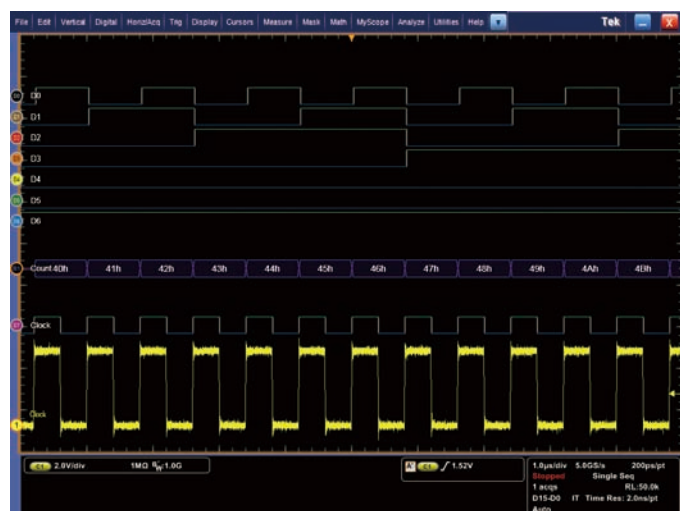
デジタル波形はカラー・コードで、ローの値は青で、ハイの値は緑で表示されるため、トランジションが見えても見えなくてもバスの値が容易にわかる。チャンネルごとにスレッシュド電圧を設定でき、16種類のロジック・ファミリに対応できる
