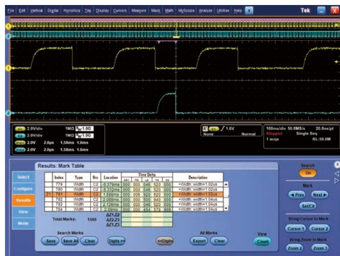
検索手順2：Wave Inspectorは波形メモリを自動的に検索し、該当イベントに三角 (▽) でマークを付けて記録。(←)、(→) ボタンを押して次のイベントに移動
