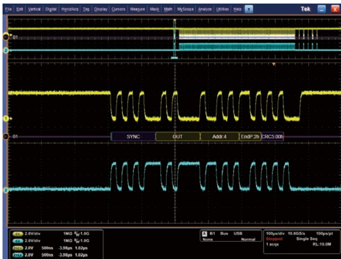
USBフルスピード・バスのOUTトークン・パケットにトリガした例。バス波形は、スタート、シンク、PID、アドレス、エンド・ポイント、CRC、データの値、ストップなど、デコードされたパケットの内容を表示
