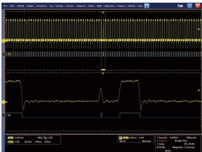
MagniVu高分解能モードでは60.6psのタイミング分解能が得られ、デジタル波形の正確なタイミング測定が行える
