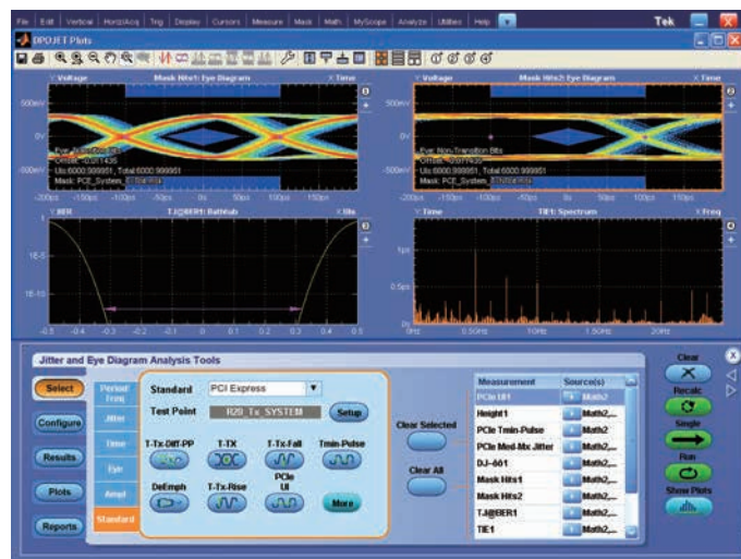
PCI Expressコンプライアンス・テスト・ソリューション (Opt. PCE3) — 総合的なテスト・サポートにより、PCI-Express Rev 1.0、2.0、3.0の設計性能を解析する。DPOJETの使用により、PCI-SIGの適合性をテストできる
