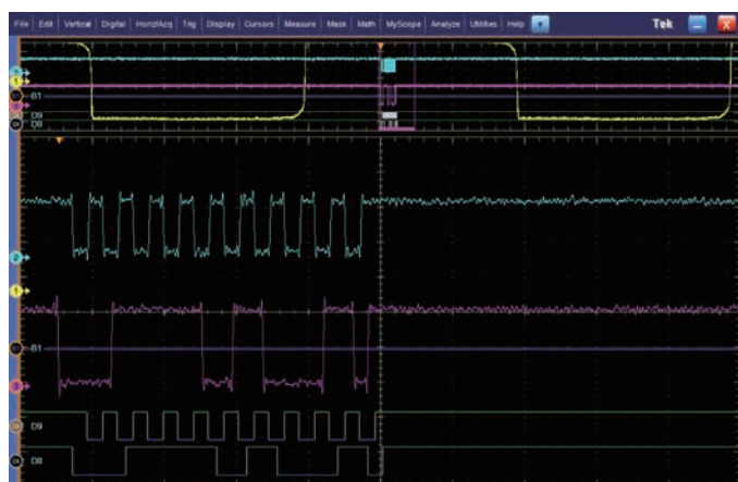
ロジック・チャンネルの統合 — システム・デバッグにおけるアナログとデジタルの相関関係がとれる
