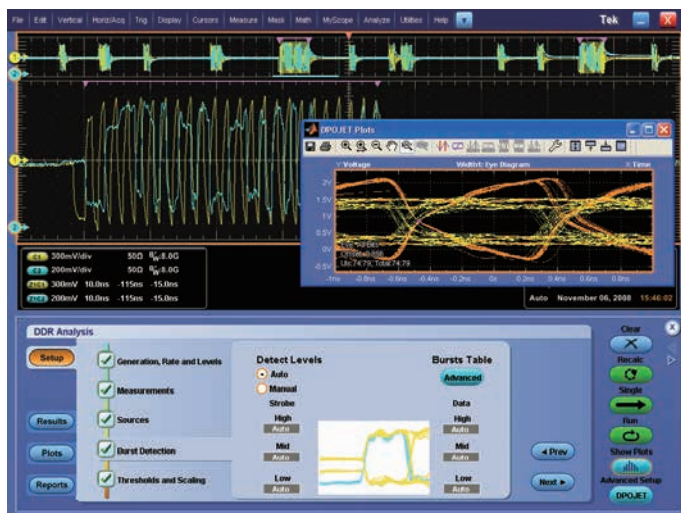
DDRメモリ・バス解析 (Opt. DDRA) — DDR1、LP-DDR1、LP-DDR2、DDR2、DDR3、GDDR3のリード/ライトを自動的に識別し、すべてのリード/ライト・バーストにおいてJEDEC適合性測定を行い、バス/フェイル結果を表示する。また、クロック、アドレス、コントロール信号も測定できる。さらに、DPOJETでDDRAの適合性試験を実行することで、複雑なメモリ信号問題をすばやく解決する。16チャンネルのデジタル・ロジック・プロービングが可能なMSO7000Cシリーズ・ミックスド・シグナル・オシロスコープでは、コマンド/アドレス・ラインを使って特定のリード/ライト・ステートにトリガしたり、リード/ライト識別にも利用したりすることができる
