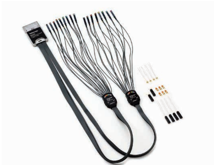
P6780型差動ロジック・プローブは、最高16チャンネルのロジック信号を広帯域に取込むことができる
