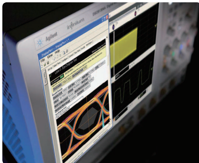
DisplayPort電気テスト・ソフトウェアの結果レポートには、テスト項目、合格／不合格、仕様範囲、測定値、マージンが表示されます
