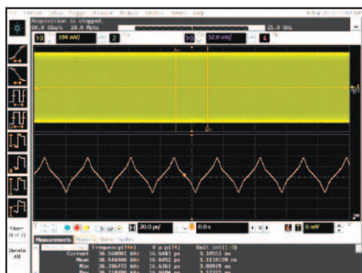
EZJITソフトウェアによるスペクトラム拡散クロックの抽出
