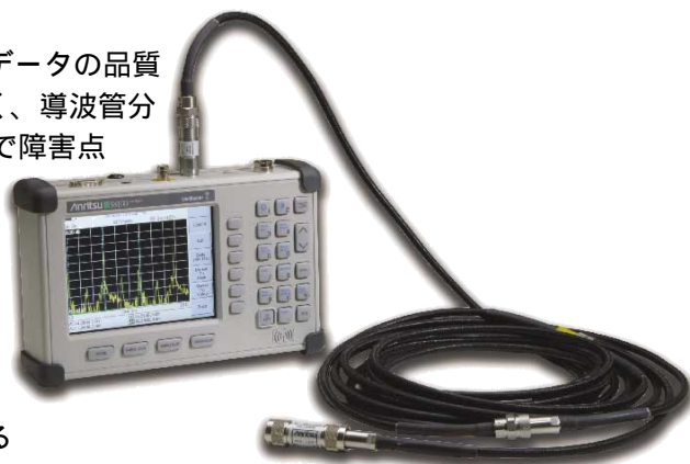
遠端側にショートコネクタを接続し、もう片端に測定器を接続して測定します。
