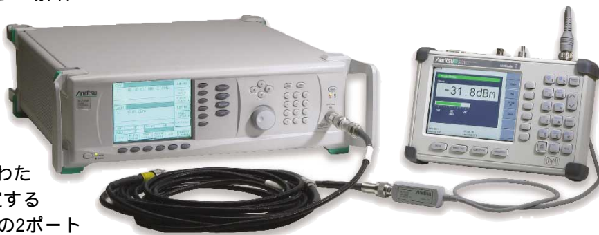
パワーモニタを使用して、外部シンセサイザを使用し電力測定を実行します。
