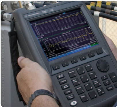
リターン・ロス測定と障害位置検出測定の実行と表示が同時に行えます。
