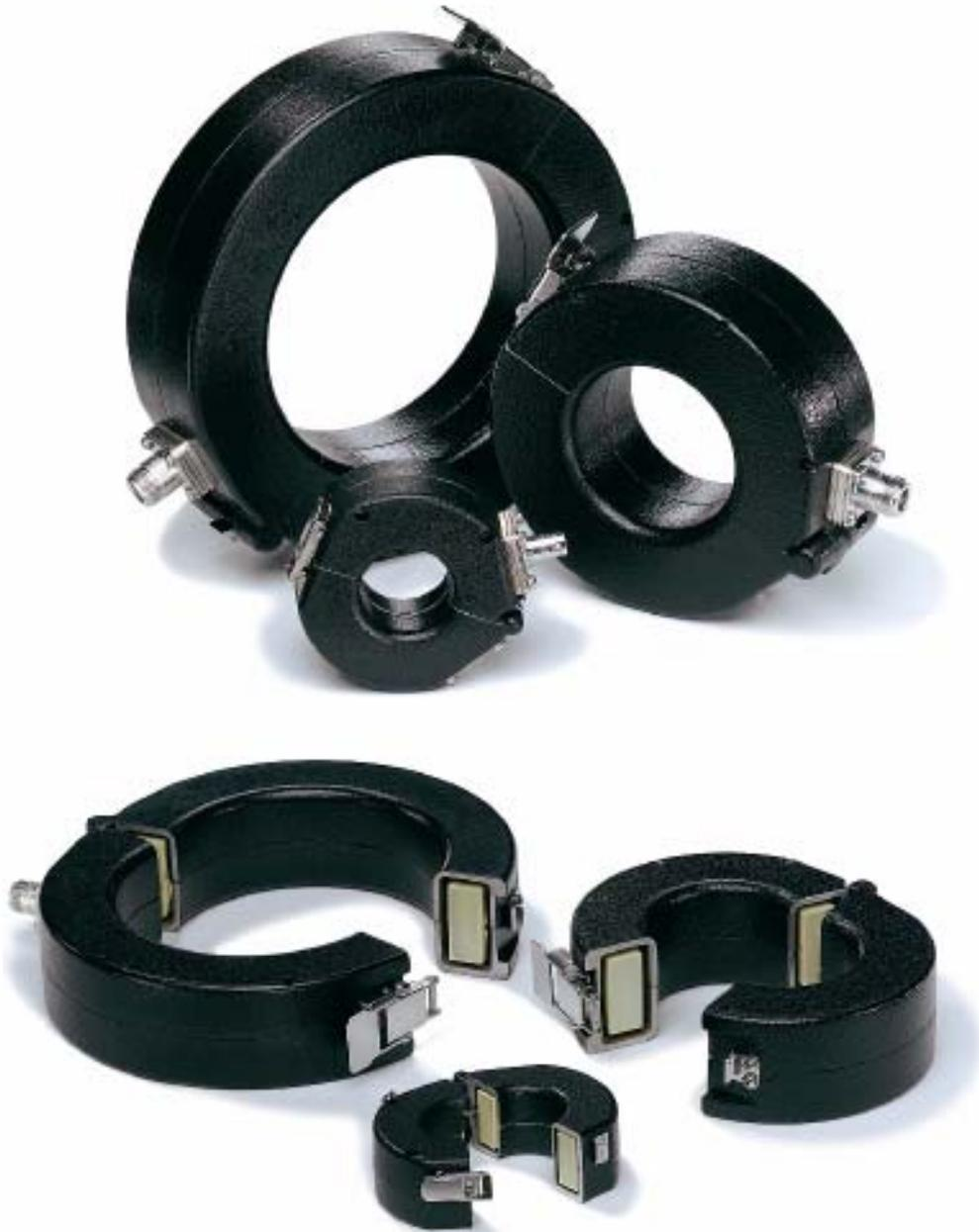
ETS-EMCO カレント・プローブはクランプ型を採用しているため、被測定線路を取り外すことなく簡便に被測定線路の電流を測定することができ、EMC の最終適合試験はもとより EMC の予備診断試験に幅広く活用されています。
