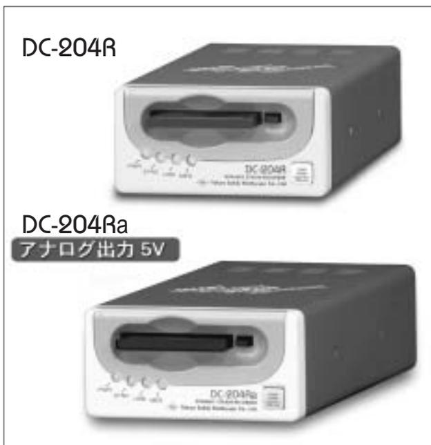
本器はコンパクトフラッシュ記録型的高速小型4チャンネル動ひずみ測定器です。1チャンネルモードで200kHzの高速サンプリングが可能で、8台を並列に接続することで最大32チャンネルの同時サンプリングが可能です。
