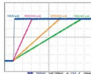
●スルーレート可変による電流波形の推移
