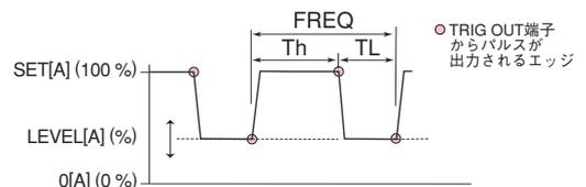
【設定パラメータ】 ■動作モード:CC および CR ■デューティ比設定:5% ~ 95% 0.1% ステップ ■周波数設定範囲:1Hz ~ 20kHz ■周波数設定分解能:1Hz ~ 10Hz にて 0.1Hz / 10Hz ~ 100Hz にて 1Hz / 100Hz ~ 1kHz にて 10Hz / 1kHz ~ 20kHz にて 100Hz ■周波数設定精度:± (0.5% of set) ※デューティ比設定の最小時間幅は 10 μs です。
