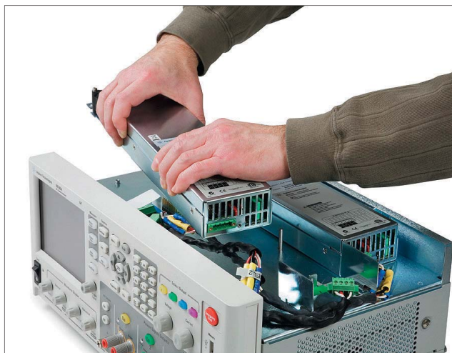
図2. DC電源モジュールは、N6705A DC電源／アナライザ・メインフレーム内に簡単にインストールできます。
