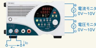
\*モニタリング用端子の(-)側電位は、出力(-)端子と同電位になります。事故や誤動作防止のため、接続機器はフローティング状態でご使用ください。
