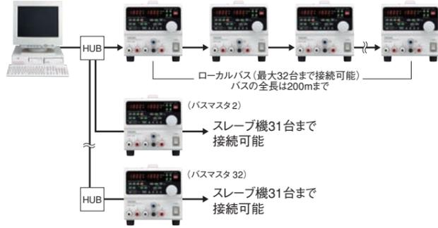
（注）IF-41GUを使用したUSB及びGP-IBコントロール時のバスマスタ、スレーブ、各スレーブ間の接続にはツイステッドケーブルをご使用ください。また、選択される線材は以下の範囲内して下さい。
