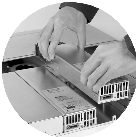
図6. ユーザによる再構成が可能なモジュラ・システム
