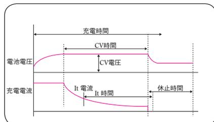
【終止条件】 時間、CV 時間、電流、温度
