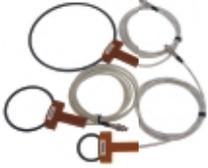
本プローブは、当社のINSシリーズに接続し、電子機器内部の配線(PCボード)等に電磁界による輻射ノイズを与え、電子機器の輻射ノイズに弱い部分を探索するためのものです。
