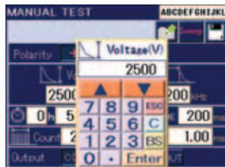
極性切替等選択する試験条件はボタンのオン/オフで設定します。数値設定するパラメータは画面に触れると、テンキーが表示されますので、簡単に入力が可能です。
