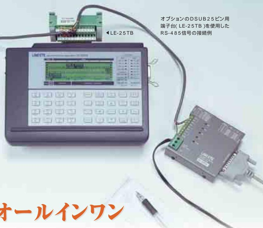
オプションのDSUB25ピン用端子台(LE-25TB)を使用したRS-485信号の接続例
