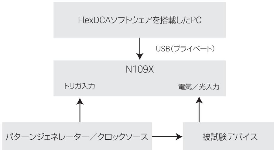
トランスミッター・コンプライアンス・テストを実行するのに必要な基本測定(例えば、アイマスク、消光比、その他のアイダイアグラムパラメータなどのテスト)は、N109XとN1010Aを組み合わせたシステムの標準機能です。コストを削減するためにN1090Aは86100のパターンロック機能を備えていませんが、N1092/4ではオプションPLKを追加すれば可能になります。パターンロックが必要な機能には、オプション200(アドバンスドジッタ解析)/201(アドバンスド波形解析)/300(アドバンスド振幅解析/RIN)、オプションIRC(光チャネルの動作範囲を±50%拡張し、10~42 Gb/sの任意のデータレートで基準レシーバーを作成する機能)、オプションSIM(Infinisim波形変換ソフトウェア)があります。N1090Aシステムでパターンロックが必要な測定機能は実行できません。N1090Aを使用した場合、パルスの基本オシロスコープモード測定は、2 ns未満のパターンに制限されます。
