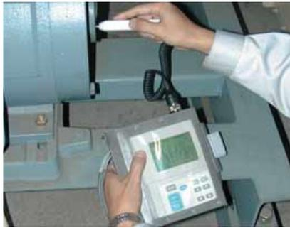
ピックアップはペンシル型なので、測定ポイントに押し当てるのが容易です。さらにピックアップPV-57A(オプション)の使用が可能。[マグネットアタッチメントVP-53S(オプション)使用]
