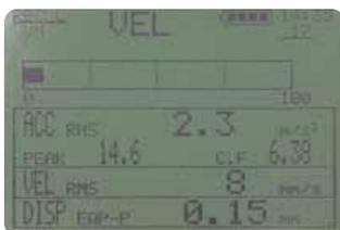
最新の電子技術を導入し、振動計測をすべてデジタル演算処理することにより、加速度の実効値・ピーク値・クレストファクタ・速度・変位の5つの値を、一度に測定できるので、設定の手間が省けます。
