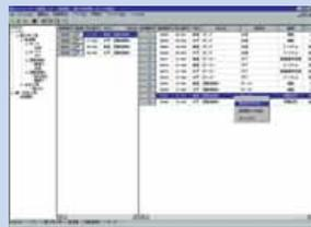
管理すべき設備を階層化して登録、設備台帳の作成、路順表の作成、データコレクタへの路順表のダウンロード、測定データのグラフ化、プリントアウトなどが可能。
