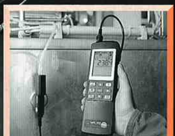
フィルタ交換時の差圧計測
