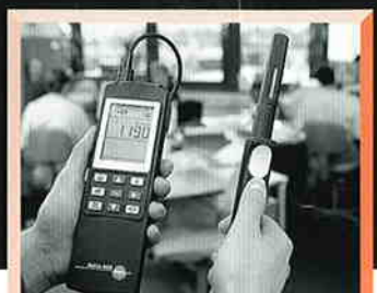
CO 2 プローブを使用して 室内空気品質のモニター
