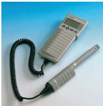
指示計HMI41、プローブHMP45
