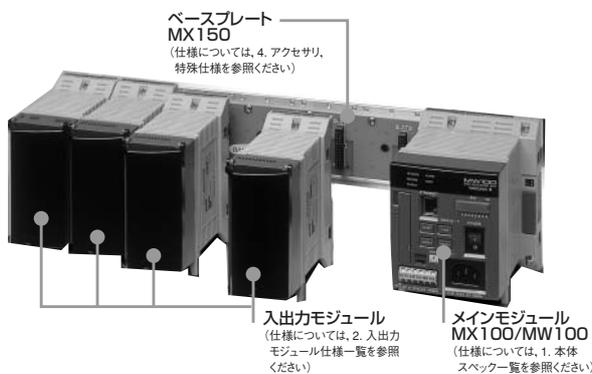
メインモジュール、入力出力モジュール、ベースプレートの3種を組み合わせてお望みの測定環境を構築します。組み上がったものはそのままデスクトップユースとしてお使いいただけます。なお、ラックマウントやパネルマウントには DIN レールを使用します。(DIN レールマウント用ブラケットは MX150 に標準添付されています。)
