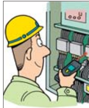
■ 電気配線の温度異常チェック
