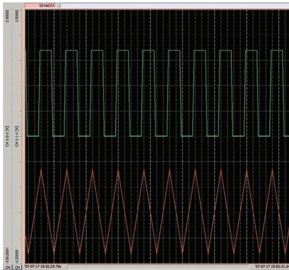
5Hzのパルス波形を、10msec (上段) と100msec (下段) のデュアルサンプリングで測定 (時間軸: 50msec/マス)
