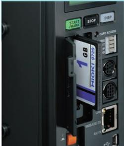
CFカードスロットを標準装備。HIOKI製CFカード（HIOKI製以外は動作保証外）に1GBまで対応。8423の設定条件を、CFカード経由で他の8423にコピーする事も簡単です。
