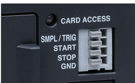
外部トリガ、外部スタート、外部ストップ、外部サンプリングの入力端子を標準装備しています。外部から信号を入力することによって、入力信号をトリガソースとしたり、測定開始や測定停止を実行することができます。また、計測したい任意のタイミングで、データを取得する事が可能です。
