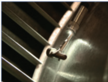
アリゲーターツールにより落下したボルトを回収
